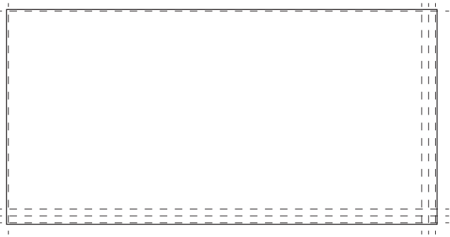
2500 x 1250 4 x Kantensäuberungsschnitte 4 x Abschnitte als 45° Gehrungsschnitte: 40 mm
